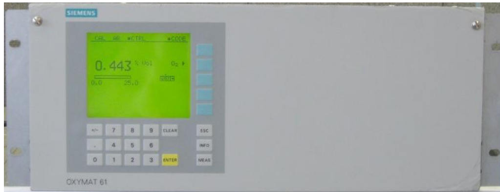
Рисунок 3 – Газоанализатор Oxymat 61, внешний вид
