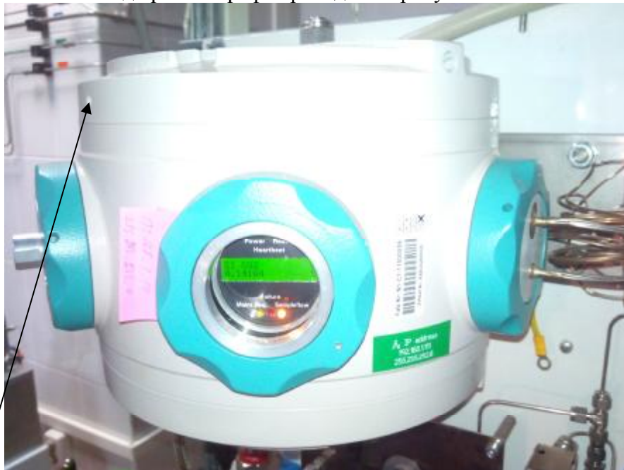
Рисунок 1. Внешний вид хроматографа газового промышленного специализированного MicroSAM
